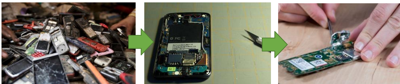
Figura 8: Dal sorting al pre-trattamento: separazione di componenti e materiali
